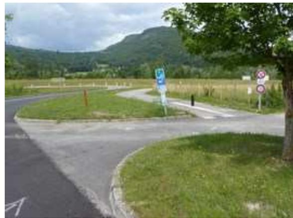
*Entrées de voie verte avec des angles de giration trop courts, potentiellement gênant pour des tandems ou vélos avec remorque, Murs et Géligneux (01)*
