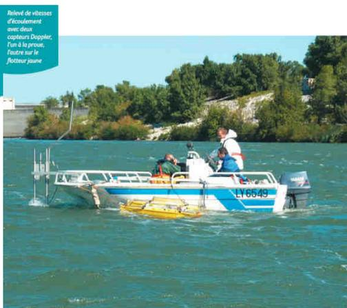
Relève de vitesses d'écoulement avec deux capteurs Doppler, l'un à la proue, l'autre sur le flotteur jaune
